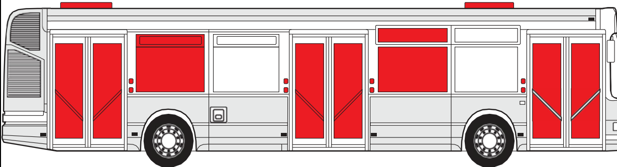
Рис. 6.4. Елементи аварійних виходів з автобуса (позначені червоним)
