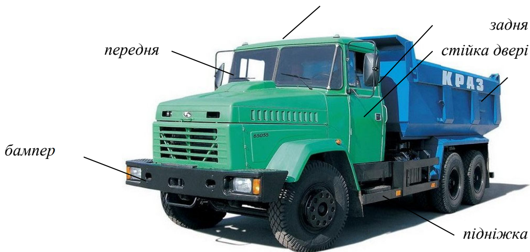
Рис. 6.2. Основні елементи кузова вантажного автомобіля
